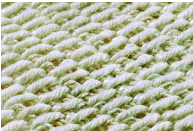
Цельнотканый каркас перед пропитыванием поливинилхлоридом
