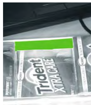
(В) Камера технического зрения “pixel counter” обнаруживает отсутствие слоя, контролируя область стенки внутри картонной коробки.
