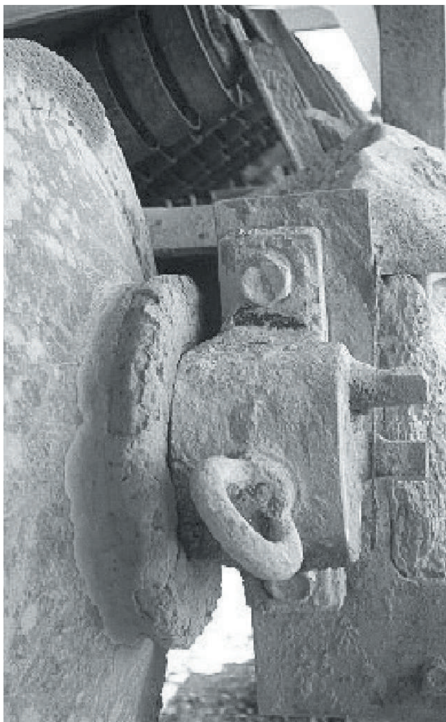
Применение: удобрения и химикаты. Продолжает работать в агрессивной среде уже более 30 лет.
