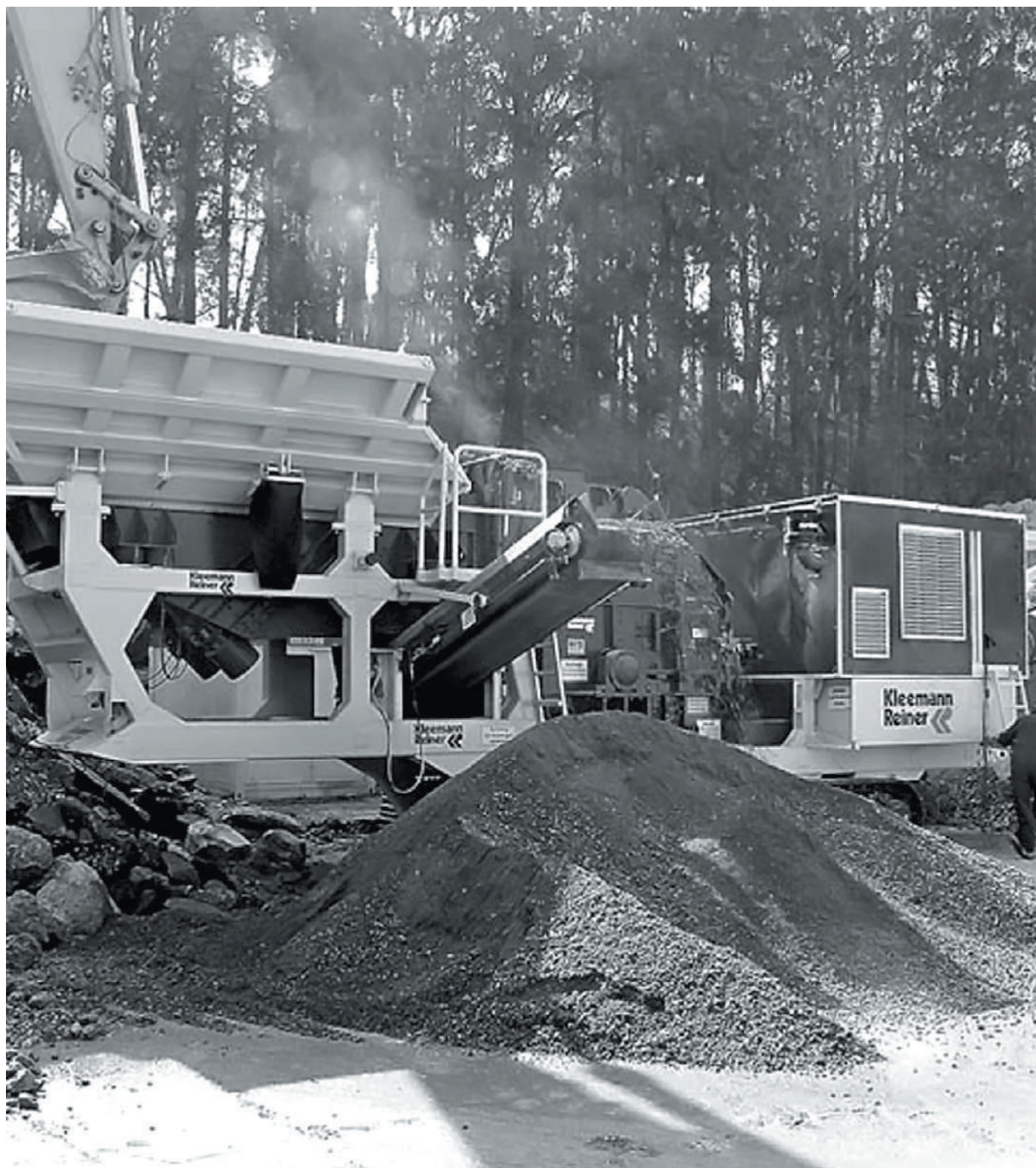
Применение на мобильных дробильно-сортировочных установках. Преимущества мотор-барабана: компактный, легкий, вписывается посередине в габариты рамы, надежный, не требует ухода.
