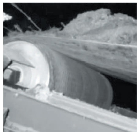
Установки рисайклинга с мотор-барабанами выигрывают за счет высокой степени защиты. В сочетании с лабиринтными уплотнениями с возобновляемой смазкой обеспечивается эффективная защита привода от внешних воздействий. Система уплотнений препятствует проникновению таких материалов, как видеопленка, текстиль и т.п.
