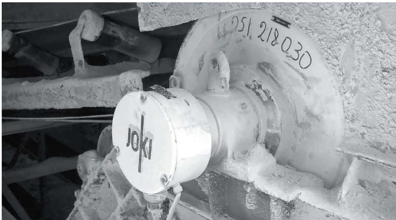
Применение в производстве удобрений в пустыне – агрессивные условия окружающей среды Особенности мотор-барабанов: лабиринтные уплотнения IP66/67, класс изоляции H, никакого ухода кроме регулярной смазки, работа с преобразователем частоты
