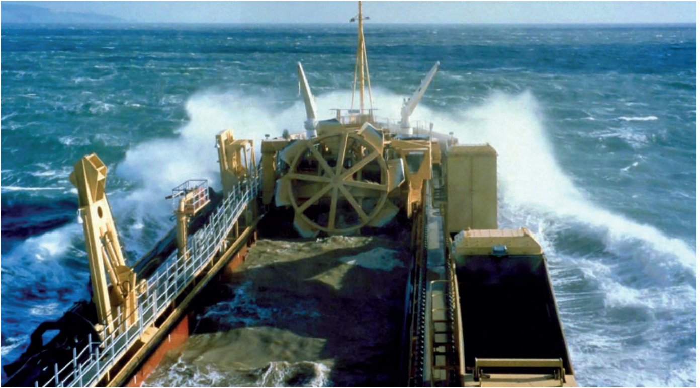
Добыча песка и гравия из Северного моря во время прилива и разгрузка во время отлива в доке – короткий промежуток времени между отливом и приливом и большая производительность (2700т/ч) требуют высокой скорости ленты 3,15 м/с.
